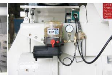
全自动油脂润滑 Automatic grease lubrication
